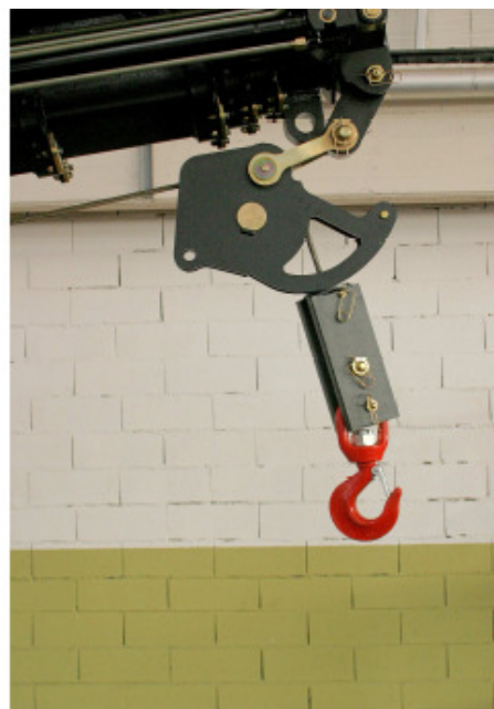
Aktywacja mechanicznego zatrzymania suwu liny
